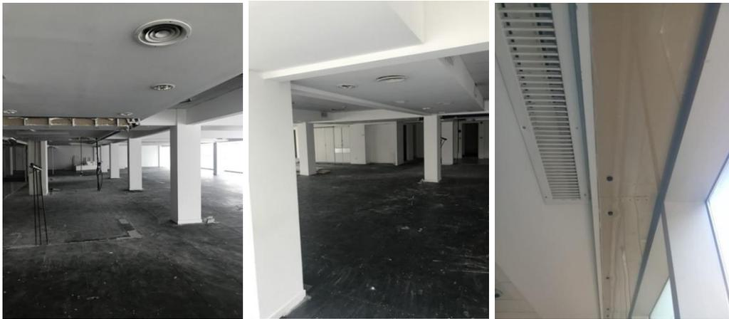
Actualmente están instalados los artefactos de iluminación con los que se equiparon dichos pisos en su momento. Se deberá completar la instalación eléctrica (bocas de iluminación, tomacorrientes) según requerimientos del nuevo proyecto; así como también cambiar todos los artefactos existentes por nuevos con tecnología led, según especificaciones del pliego.
