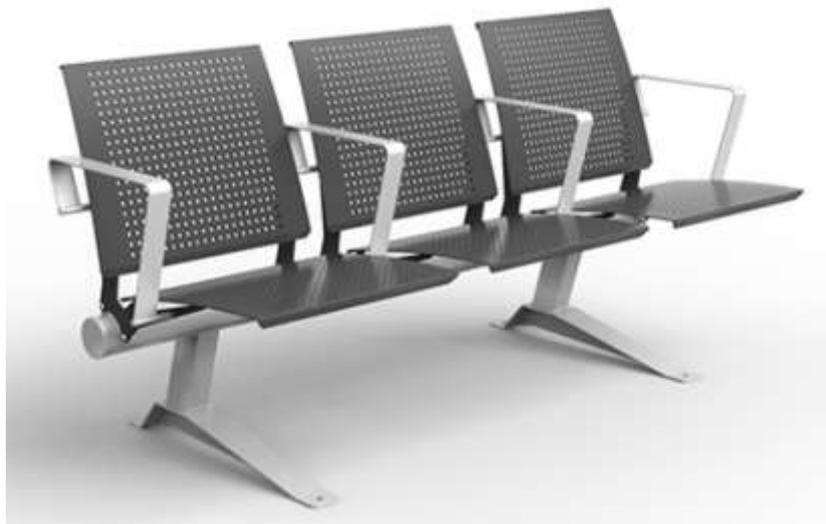
RESPALDO Y ASIEN TO: Fabricados por piezas de chapa perforada de 3,2 mm (con una posible variación en +/- 10%) de espesor. Los mismos deberán tener un acabado de pintura electrostática de poliéster, color en la gama de los grises a definir por el DSGM.
