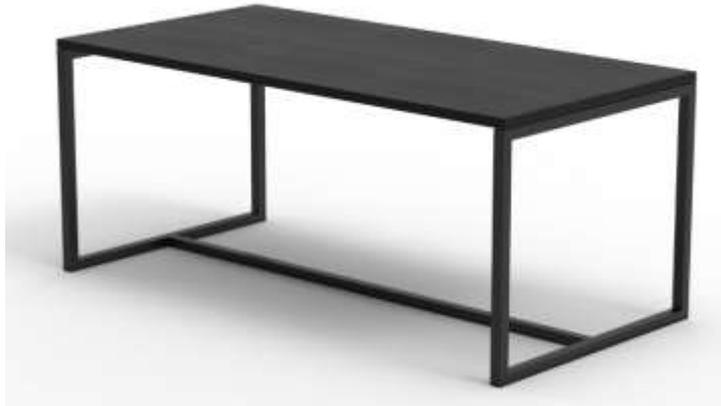
**TAPA SUPERIOR:** Tablero de MDF revestido en ambas caras con láminas decorativas impregnadas en resinas melamínicas con certificación ISO 9002 y FSC (Forest Stewardship Council) tipo Faplac línea “hilados” color LINO NEGRO (1.00 m x 0.55 m) de espesor 25 mm. Terminación en canto perimetral ABS duro extruido certificado bajo norma ISO 9001 tipo Raukantex de Rehau de 2mm de espesor y fresado de aristas.
